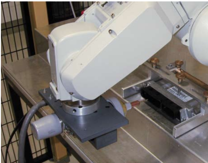
Die Pistole TC-815R in der ISO 10605 Roboter-Prüfapplikation.
